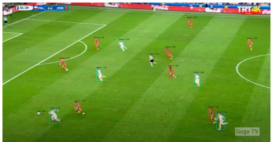
El sistema de seguimiento óptico basado en IA y computer Vision recopila automáticamente datos de seguimiento del esqueleto del jugador a partir de cualquier grabación de una sola cámara de un acontecimiento deportivo (por ejemplo, una retransmisión televisiva).
